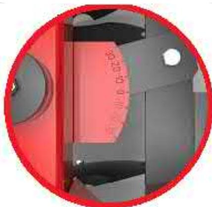
**Регулировка угла атаки**
