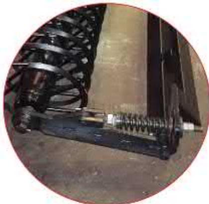
**Пружинно-винтовой механизм опоры катка,**
